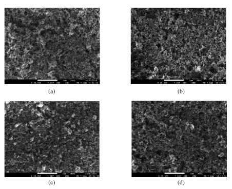
FIGURE 1. FESEM images of  $TiO_2$  thin films annealed at (a) 300°C, (b) 400°C, (c) 500°C and (d) 600°C
